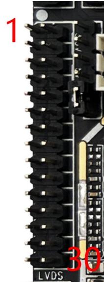
● LVDS 屏电压跳帽接口 (LVDS LCD JP JACK) 座子间距 1.25MM
